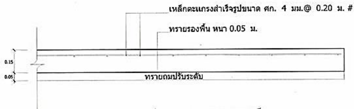
รูปขยายการวางตะแกรงเหล็ก
